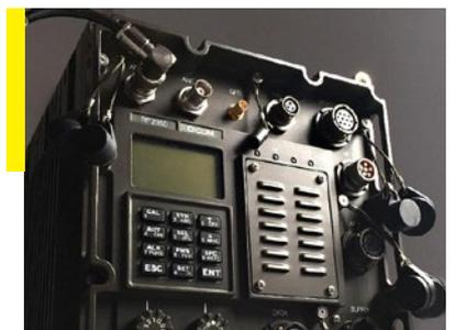
La estación de radio móvil RF2350 es parte del sistema de radio RF20. Se distingue por su gran resistencia contra la lucha radioelectrónica. Está diseñada para ser instalada en todos los vehículos a ruedas y a la estación base.
