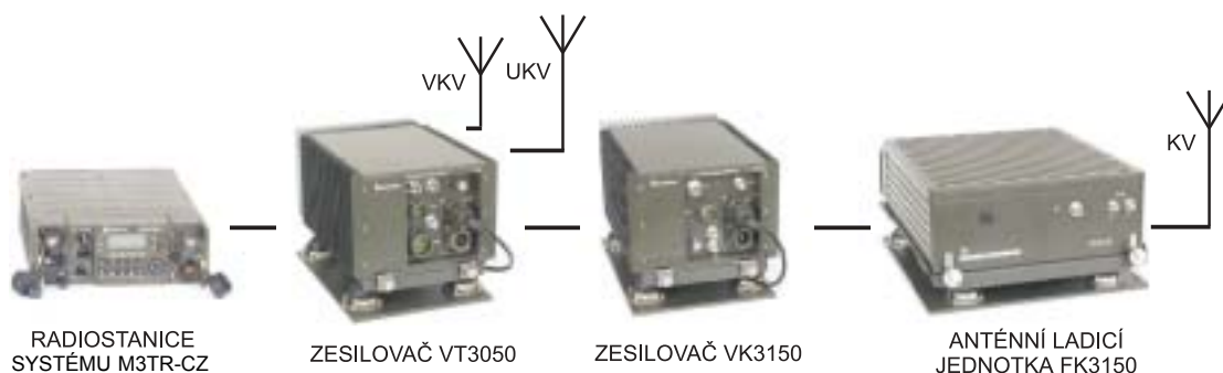
Obr. 1 Blokové schéma soupravy M3TR-CZ se zesilovači v výkonu a anténní jednotkou
