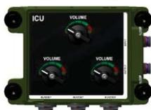
Permite conectar tres sistemas auriculares (ANR) al sistema de intercomunicación. Las personas conectadas al ICU pueden monitorear la radio del vehículo.
