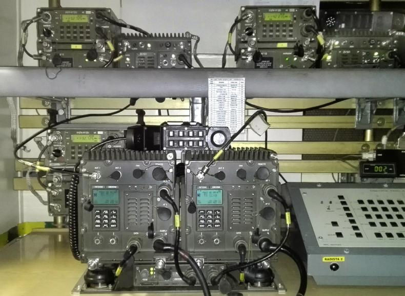
L'unité de retransmission automatique AR20 est un appareil permettant une retransmission automatique en liaison avec des stations radio à fréquence fixe répondant aux exigences de la norme STANAG 4204 et des stations radio communiquant en mode de saut de fréquence rapide, à l'aide du modulateur d'ondes HW20, c'est-à-dire les stations radio RF20, RF2050, RF23, RF2350.
