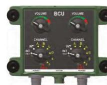
Zajišťuje plnohodnotné připojení s nezávislým ovládáním hlasitosti dvou náhlavních souprav (ANR) s přístupem do vnitřního spojení i k vozidlovým radiostanicím.
